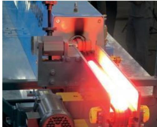
‘power-to-steel’ induktive Erwärmung von Rohlingen vor der
